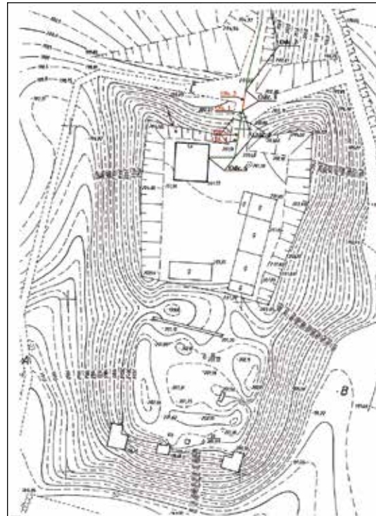
Ryc. 3. Mapa sytuacyjno – wysokościowa w skali 1:500 założenia zamkowego, z naniesionym wykopem inwestycyjnym i odkrytymi obiektami (według J. Niedźwiedzia i A. Medaka). Opr. S. Gołub, E. Poźniak
