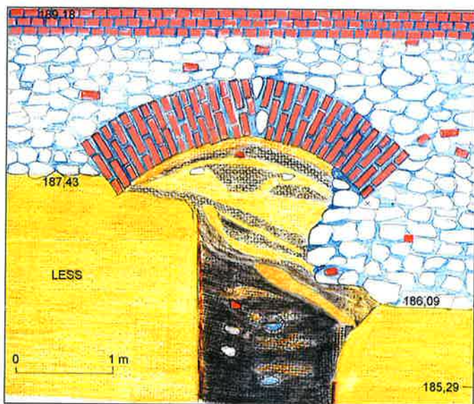
Ryc. 5. Lublin. Kamienica przy ul. Grodzkiej 30. Mur działowy w obrębie oficyny. Poniżej łuku odciążającego widoczna jest górna część zasypanej studni – latryny. Rys. Andrzej Hunicz.
