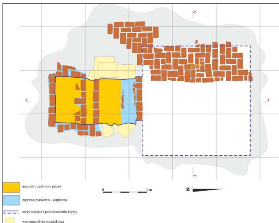
Ryc. 4. Rzut wejścia i pomieszczenia krypty 2 oraz widok ceglanej posadzki ułożonej częściowo nad sklepieniem krypty. (rys. D. Włodarczyk)
